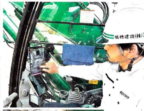
シャベルの位置をICT建機内部の画面で確認する小坂橋さん。ICT建機で描いた巨大文字「START」。業界の魅力向上への思いを込めた
